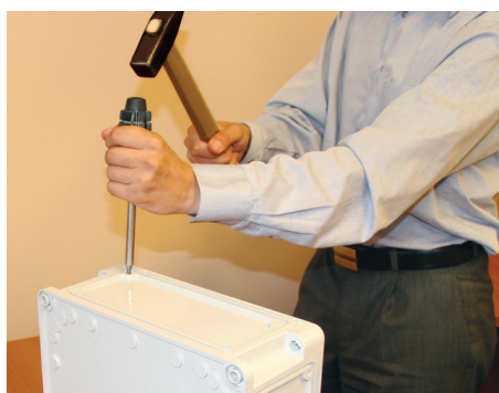
1. Удалите соединительные отверстия
