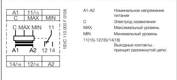
Схема подключения CM-ENS
