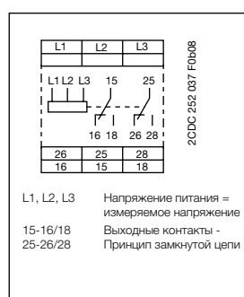
Схема подключения CM-PAS.x1
