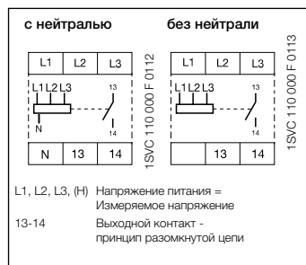
Схемы подключения CM-PVE
