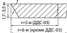
ДДС Зона обнаружения по вертикали (вид сбоку)
