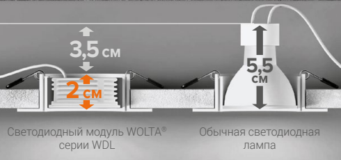
Сравнение габаритов светодиодного модуля и лампы GU10
